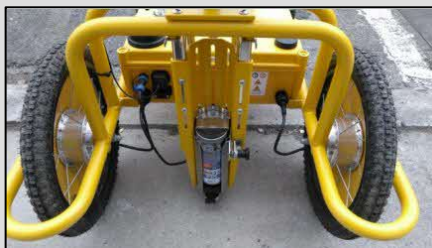
スプレー缶設置状況
